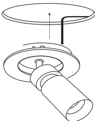
Встраиваемый светодиодный светильник цилиндрической формы. Предназначен для акцентного освещения и выделения различных зон. Поворотная часть позволяет направлять свет в необходимую сторону. Варианты отделки: матовая чёрная или белая краска.
